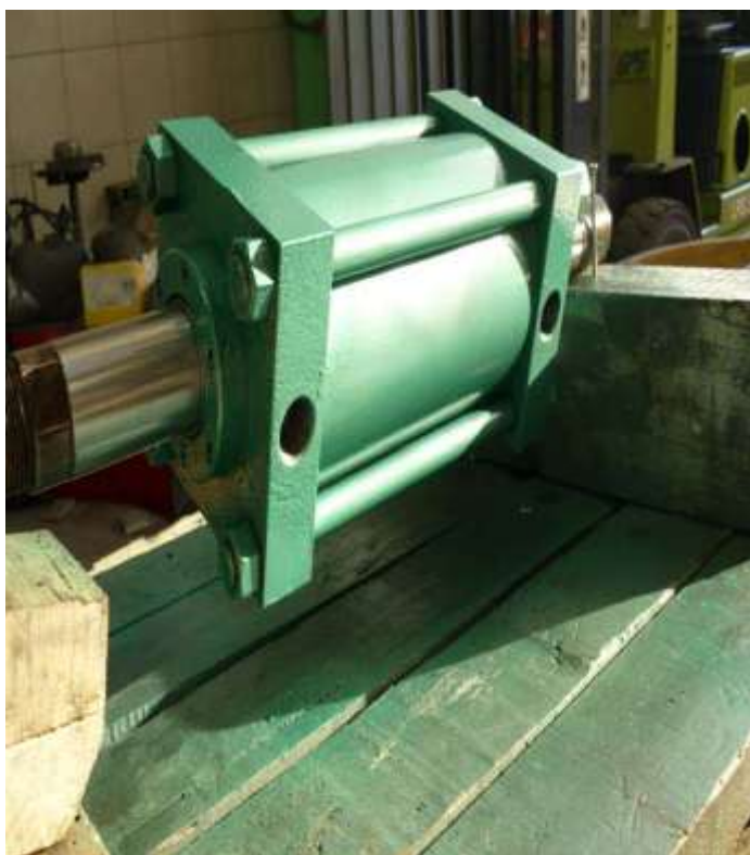
Cilindro reparado en preparativo para su control final y embalaje.
