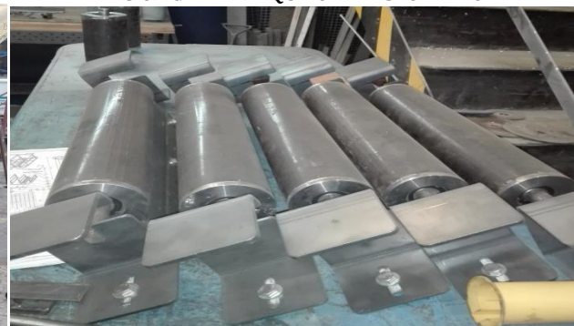
3 - CONSTRUCCION Y MONTAJE RODILLOS CUNA BASE Y RETORNO CON RASCADORES
