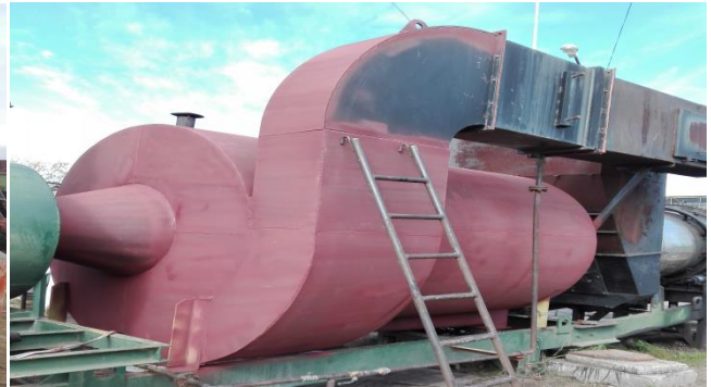
5 – Ciclón pintado con convertidor + pintura
