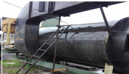
3 – Comienzo de armado de paneles de chapa
